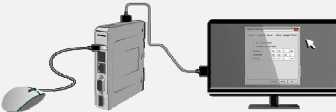
Cuando el mTV se haya encendido y muestre una imagen, pulse el botón de ajuste del sistema. (Contraseña por defecto: 111111) Deberá conectar el mTV a su red local a través de un cable RJ-45.
