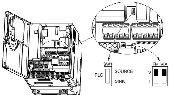
Configuración de fábrica de los interruptores deslizantes
