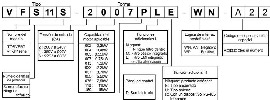
\* Este código representa el ajuste lógico predefinido en fábrica. Se puede cambiar de lógica con una entrada/salida a otro tipo de lógica mediante el interruptor deslizable SW1.
