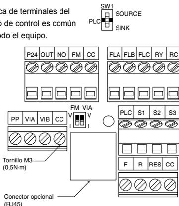
Configuración de fábrica de los interruptores deslizantes
