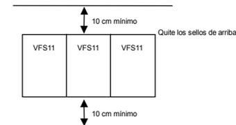
El espacio que muestra la figura es el espacio mínimo permitido. Los equipos con ventilación forzada incorporan ventiladores de refrigeración en la superficie superior o inferior, de modo que será necesario dejar el máximo espacio posible en las partes superior e inferior para permitir el paso del aire.
