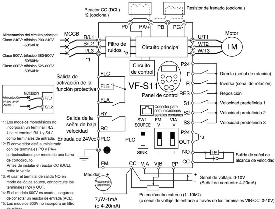
\*1: Los modelos monofásicos no incorporan un terminal T/L3. Use el terminal R/L1 y S/L2 como terminales de entrada. Antes de instalar el reactor CC (DCL), retire la varilla.
