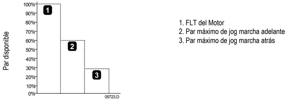
Para activar el funcionamiento jog, utilizar una entrada programable (parámetro 6D). Si se recibe cualquier otra orden cuando está en función jog, el arrancador se para y espera una nueva orden.
