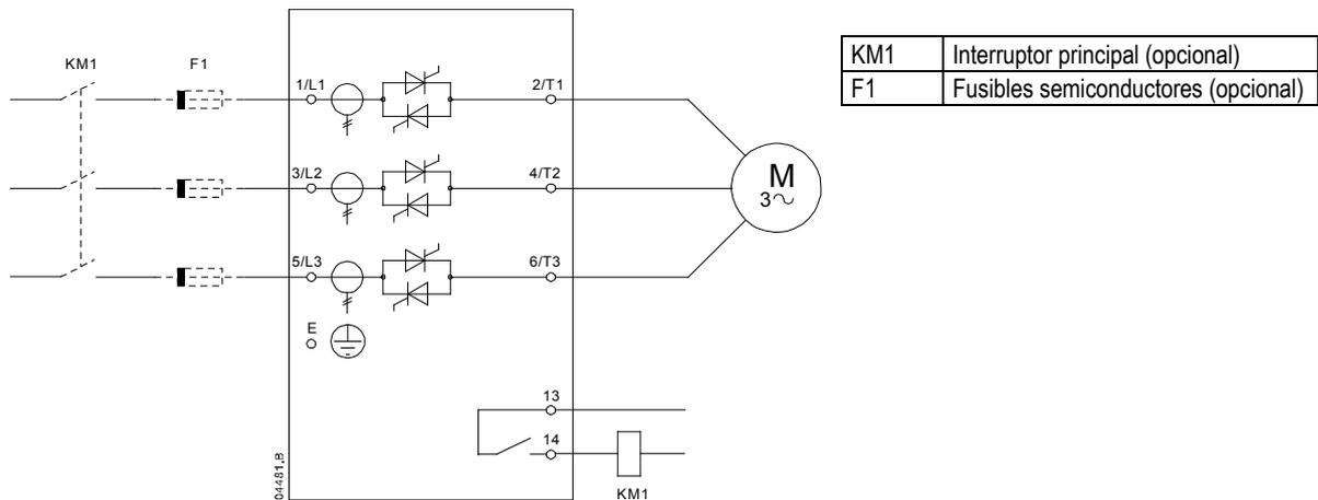
Instalación en triángulo interno, con bypass
