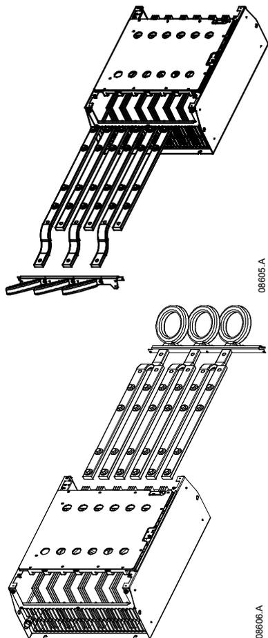
10. Desatornillar y quitar las pletinas de bypass magnéticas (sólo modelos TMS9-x280C a TMS9-x850C).
