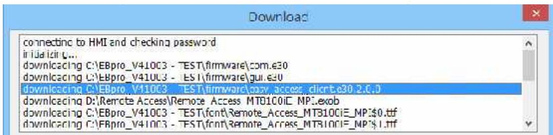
2. La hora de la HMI puede estar mal ajustada. Si la hora de la HMI es muy distinta de la hora actual, puede que la certificación de seguridad se considere expirada y que falle la conexión.
