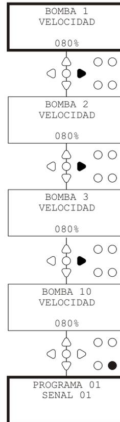
En la pantalla TIEMPO VÁLVULA DE BARRIDO (o la pantalla ASIGNACIÓN DE COLECTORES si no se necesitan válvulas de barrido) pulsar la tecla **ADELANTE/ACEPTAR** para pasar a la pantalla VELOCIDAD DE LA BOMBA/CAUDAL.
